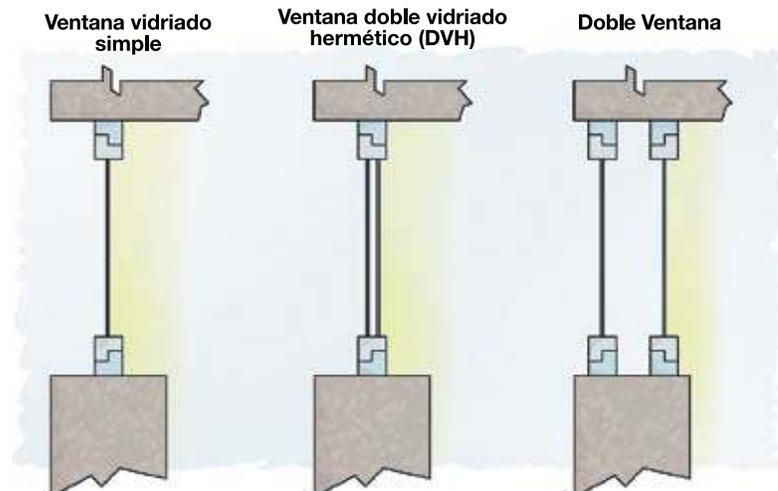
El valor de la transmitancia de un vidrio simple es 5.8 w/m<sup>2</sup>K, para un vidrio termopanel con cámara de aire de 12 mm., la transmitancia es 2.8 w/m<sup>2</sup>K y por último para una ventana doble es entre 2.4 y 3.6 k/m<sup>2</sup>K
